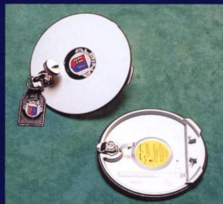
abschließbarer Aluminium Druckgußdeckel
